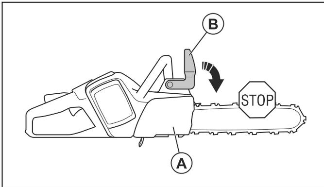
Die Art und Weise, wie die Kettenbremse aktiviert wird, hängt von der Kraft des Rückschlags und der Position des Geräts ab. Bei einem heftigen Rückschlag und wenn sich der Rückschlagbereich so weit wie möglich von Ihnen entfernt befindet, wird die Kettenbremse durch die Trägheitsfunktion aktiviert. Bei einem leichten Rückschlag oder bei einem Rückschlag in Ihrer Nähe wird die Kettenbremse manuell von Ihrer linken Hand aktiviert.
