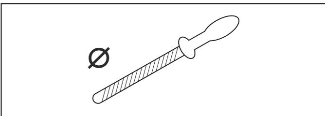
Ohne Hilfsmittel ist es nicht leicht, eine Sägekette korrekt zu schärfen. Verwenden Sie Husqvarna Schärfllehre. Dies hilft Ihnen, die maximale Schnittleistung zu erhalten und die Rückschlaggefahr auf ein Minimum zu reduzieren.
