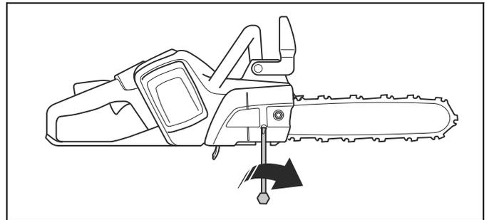
4. Ziehen Sie die Spannmutter mit dem Kombischlüssel an, und heben Sie gleichzeitig die Vorderseite der Führungsschiene an.
