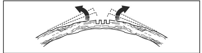
8. Sägen Sie den Baum/Ast von der anderen Seite der Biegung, nachdem die Spannung gelöst ist.
