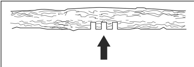
7. Sägen Sie weiter in den Stamm, bis der Stamm/Ast sich biegt und die Spannung gelöst ist.
