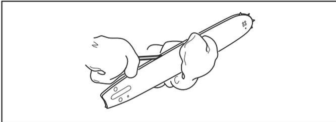
4. Überprüfen Sie die Nut in der Führungsschiene auf Verschleiß. Tauschen Sie die Führungsschiene aus wenn nötig.
