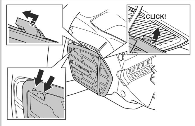
3. Schieben Sie die Abdeckung des Lufteinlasses nach links, bis die Öffnungen fluchten.
