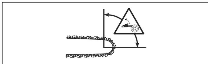
Die Kettenbremse (A) wird entweder manuell mit der linken Hand oder automatisch durch die Trägheitsfunktion aktiviert. Drücken Sie den Handschutz (B) nach vorne, um die Kettenbremse manuell zu
