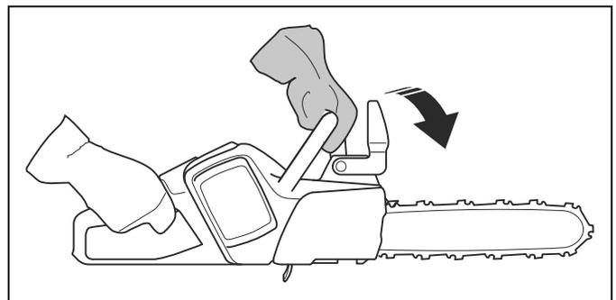
In der Fällposition können Sie die Kettenbremse nicht manuell aktivieren. In dieser Position lässt sich die Kettenbremse nur mit der Trägheitsfunktion aktivieren.
